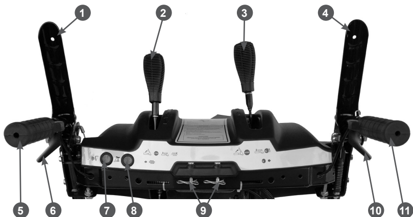
Рис. 3 Панель управления (вид со стороны оператора)
