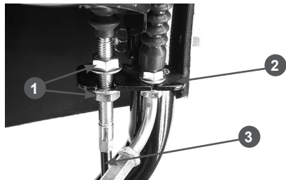
Рис. 11 Крепление оболочки троса включения хода
