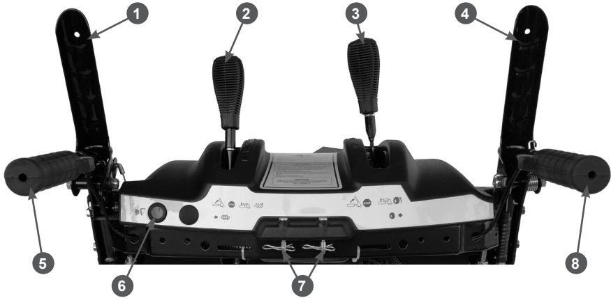
Рис. 2 Панель управления (вид со стороны оператора)
