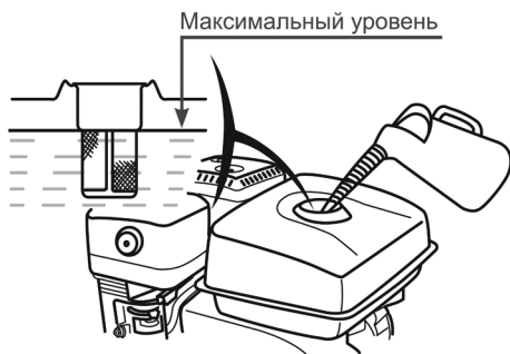
Рис. 20 Максимальный уровень топлива в топливном баке
