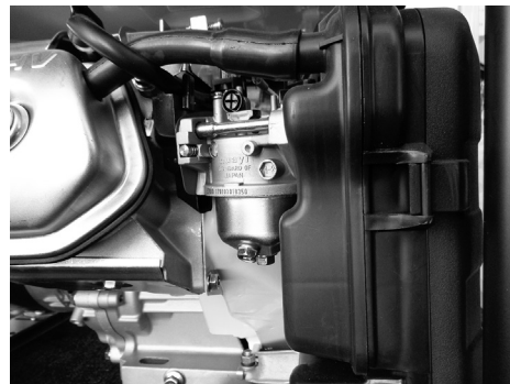
Рис. 18 Слив топлива из карбюратора
