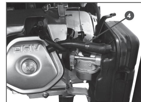
Рис. 13 Трубка системы вентиляции картера
