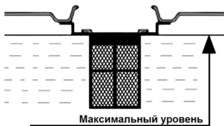
Рис. 9 Максимальный уровень топлива в топливном баке
