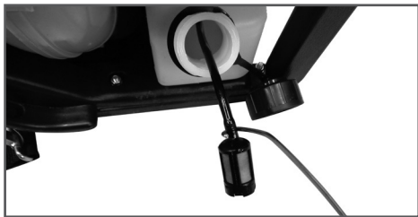
Рис. 11 Извлечение топливного фильтра
