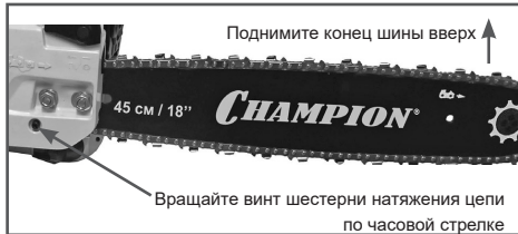
Рис. 5 Регулировка натяжения цепи
