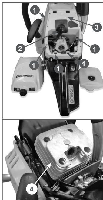
Рис. 23 Очистка охлаждающих ребер цилиндра
