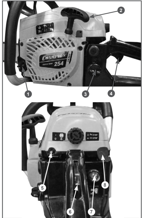
Рис. 11 Органы управления, необходимые для запуска бензопилы
