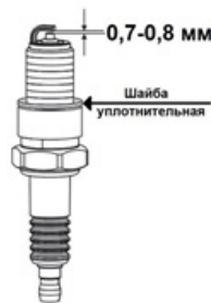
Рис. 23 Обслуживание свечи зажигания
